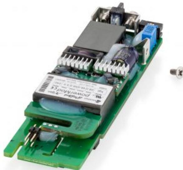
Für die Grundgeräte [UX4](#) und [UX6](#) stehen verschiedene Module zur Verfügung, die je nach Bedarf individuell konfiguriert werden können. Die Module sind galvanisch voneinander getrennt und können sowohl parallel als auch in Serie betrieben werden. Hierdurch wird eine hohe Flexibilität gewährleistet. Gerne übernehmen wir die Konfiguration für Sie.
